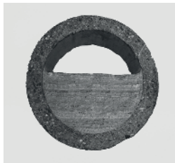
Verkalkte Wasserleitung nach 10 Jahren ohne Reinigung.
